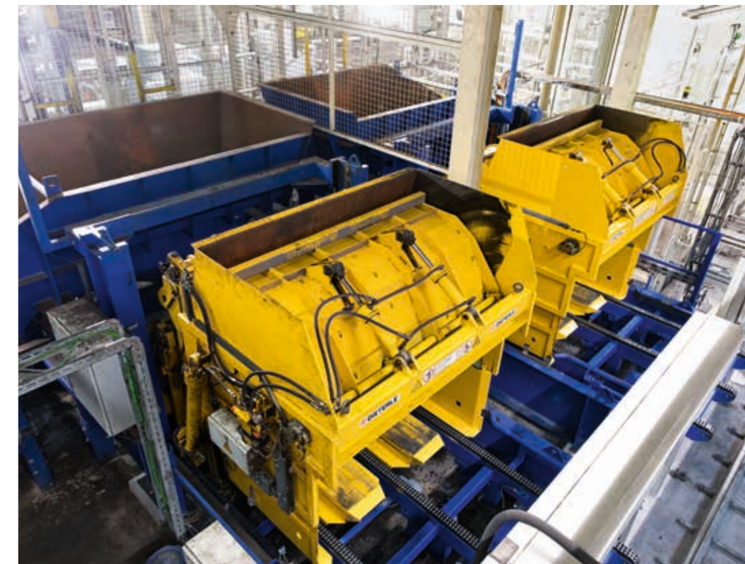
Deze hef-kantelvoorzieningen staan in voor het voorbereiden en laden van de coating voor gietbare bulkgoederen (verwerking van de trommels).
