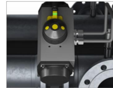
Les clapets d'entrée K1 et K2 sont équipés de série d'une surveillance des fins de course. Pratique pour la maintenance : l'affichage par LED (vert/rouge) indique la position du clapet transmise au CALOSEC CONTROL.
