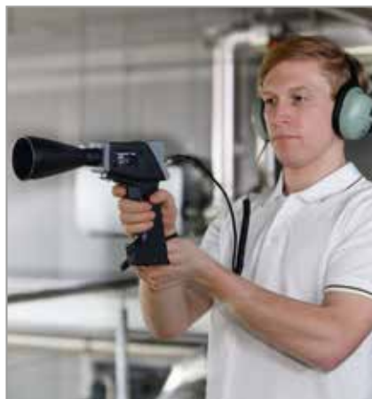
Afb. 4: Ultrasoon lokaliseren van lekken
