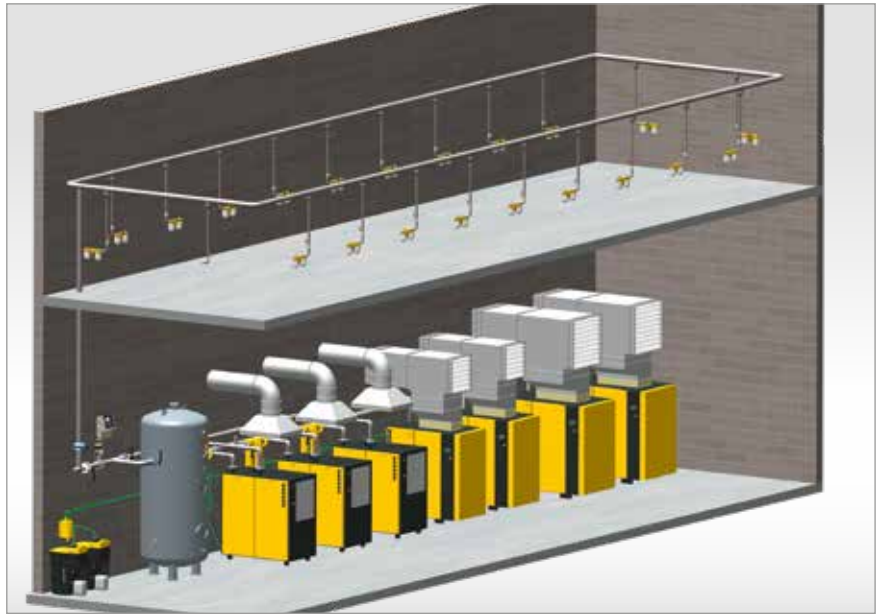
Voorbeeld van een persluchtstation met afvoerluchtsysteem en thermostatisch geregelde aanvullende ventilatie voor koeldrogers
