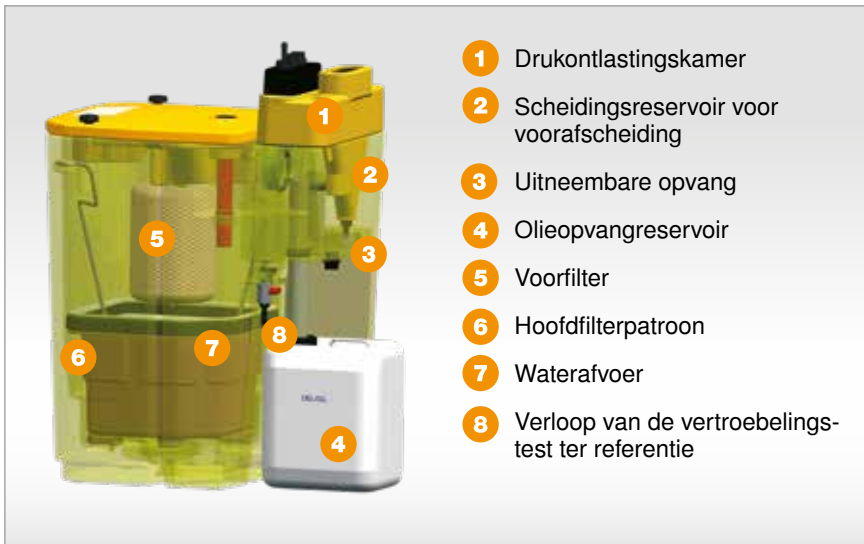
Afb. 2: Condensaatafscheidingssysteem voor persluchttechniek volgens het zwaartekrachtprincipe (afbeelding)
