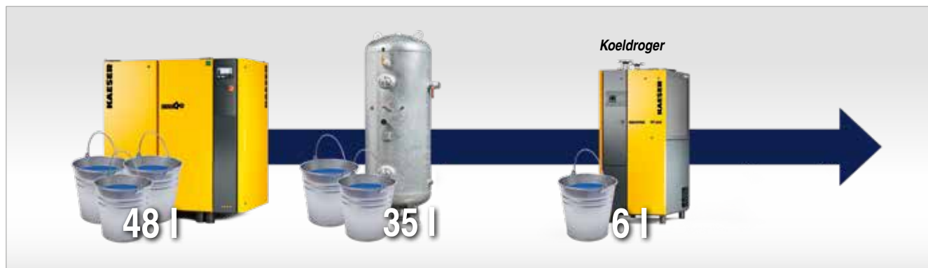
Afb. 1: Bij het genereren, opslaan en behandelen van perslucht ontstaat condensaat (gegevens hebben betrekking op 10 m 3 /min, 10 bar abs , 8 h, 60% F rel en 20 °C)
