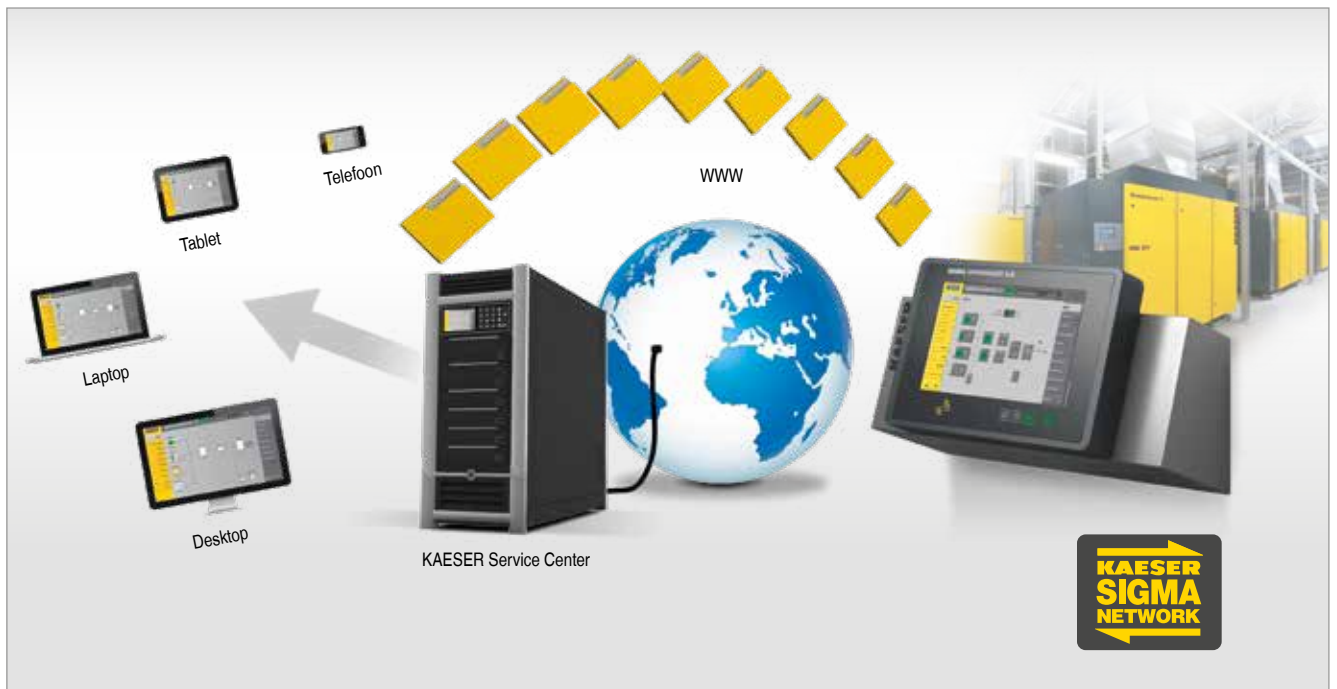
Afb. 7: Uitgebreide aansluitmogelijkheden van een overkoepelende besturing dragen bij aan een efficiënte werking van een persluchtstation
