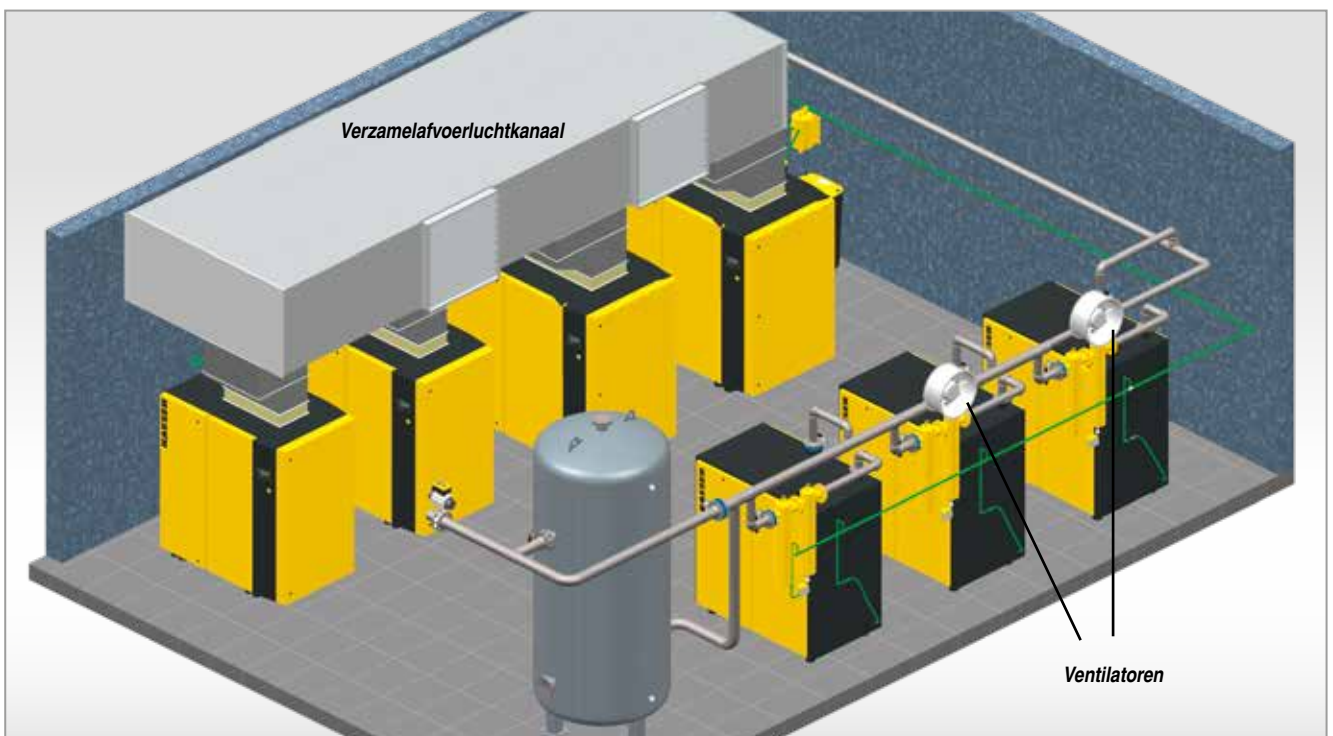
Afb. 3: Afvoerluftsysteem met verzamelluchtkanaal voor alle compressoren
