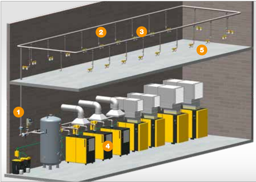
Afb. 2: Hoofdc componenten van een persluchtverdeelstelsel: hoofdleiding (1), verdeelleiding (2), aansluitleiding (3), droger (4), onderhoudseenheid/slang (5)
