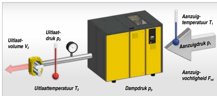
Afb. 1: Capaciteitsmeting conform ISO 1217, bijlage C (DIN 1945, bijlage F)
