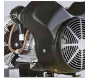
Dubbele koeling Zeer efficiënte koeling met dubbele luchtstroom; interne koeling van het carter zorgt voor een maximale druk tot 10 bar (KCT 401 tot 840).
