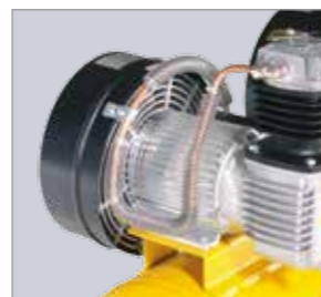
Direct gekoppeld aggregaat Aandrijfmotor direct op het compressorblok aangesloten; robuust en duurzaam dankzij laag toerental van slechts 1500 t/min.
