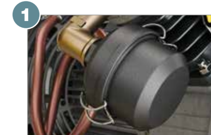
1 Aanzuigfilter met geluiddemper
