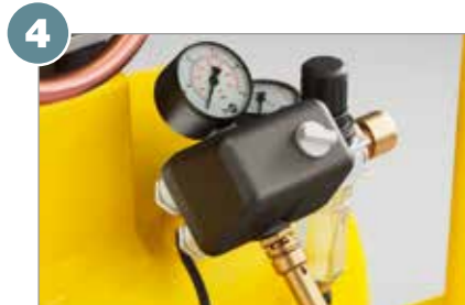
4 Drukschakelaar met startontlasting
